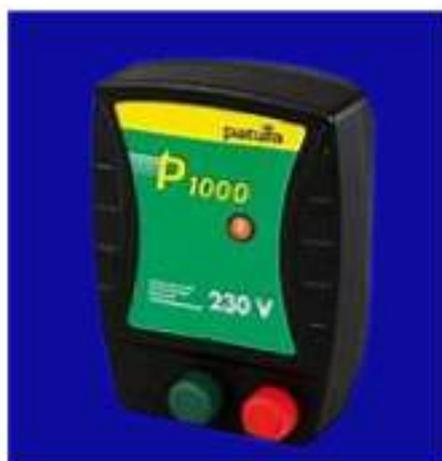
EL PASTOR ELÉCTRICO PATURA P1000 ES UN ENERGIZADOR ALIMENTADO A 220 VOLTIOS PERFECTO PARA ELECTRIFICAR PEQUEÑAS CERCAS DE GANADO EQUINO. ESTE PASTOR ELÉCTRICO DA UNA ENERGÍA ALMACENADA DE 0,75 JULIOS, CON LA QUE SE PUEDE ELECTRIFICAR UNA LÍNEA DE HASTA 5KM CON VEGETACIÓN BAJA Y CON CORRIENTE CONTINUA. ESTE PASTOR OFRECE UNA TENSIÓN AL CERCADO DE 4700 VOLTIOS.
