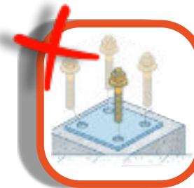
Tonilleria de anclaje al suelo
